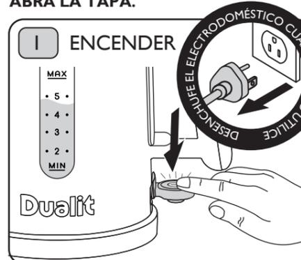
Enchufe la jarra en la toma de corriente y enciéndala. Oprima el pulsador de encendido/apagado. La luz de encendido se iluminará y la jarra comenzará a calentar el agua. Si, de manera fortuita, la jarra se enciende sin contener agua, el dispositivo de hervido en seco apagará la resistencia de calor para evitar que se estropee.
