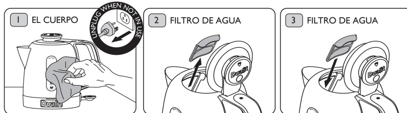
Desenchufe la jarra y deje que se enfríe completamente antes de limpiarla. Retire la jarra de la base eléctrica. Limpie las superficies internas y externas de la jarra con un paño húmedo. Cerciórese de que estén secos todos los conectores y enchufes. No sumerja la jarra o su base eléctrica en agua ni cualquier otro líquido. No utilice productos de limpieza fuertes o abrasivos ni disolventes.
