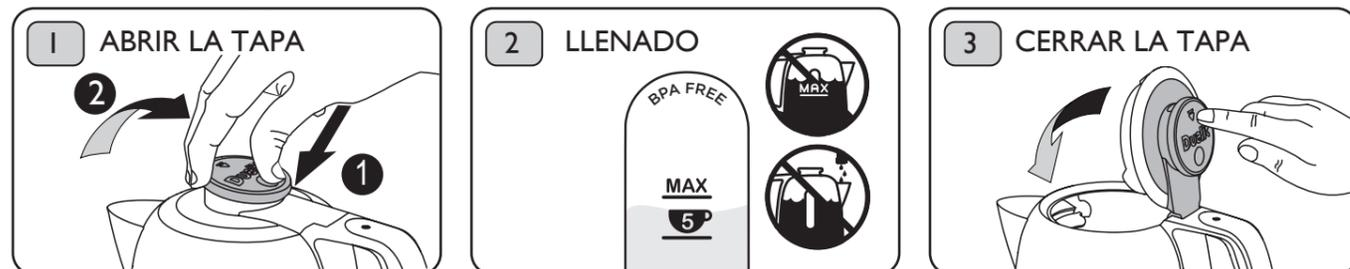
Asegúrese de que la jarra esté desenchufada. Retire la jarra de la base eléctrica. Levante la traba de la tapa como se muestra y tire hacia atrás para abrirla.
