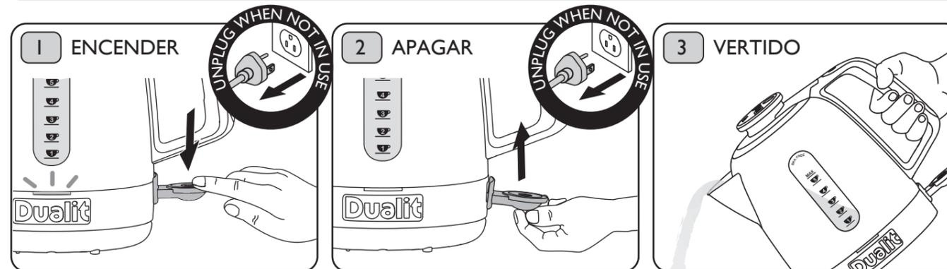
Enchufe la jarra en la toma de corriente. Oprima el pulsador de encendido/apagado. La luz de encendido se iluminará y la jarra comenzará a calentar el agua. Si, de manera fortuita, la jarra se enciende sin contener agua, el dispositivo de hervido en seco apagará la resistencia de calor para evitar que se estropee.
